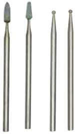
**Set de gravure sur verre, 4 pièces.** 2 meules diamantées sur tige et 2 meules sur tige en carbure de silicium. Pour gravure, taille et dépolissage du verre. Meule diamantée à tige 1 : sphère  $\varnothing$  1,0 mm, meule diamantée à tige 2: sphère  $\varnothing$  1,8 mm, cône en carbure de silicium 3/2 x 5 mm, de même que pour la forme projectile 2/2,5 x 7 mm. Chaque tige :  $\varnothing$  2,35 mm.
