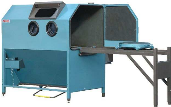
Cabine PS 1500 avec chariot de chargement extérieur
