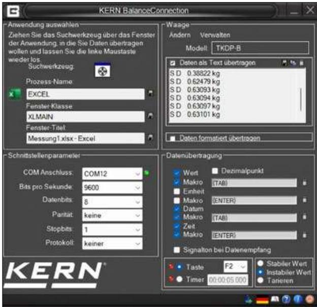
Démarrage du programme et configuration rapide de l'interface RS232/USB
