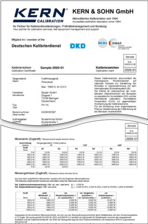
Certificat d'étalonnage avec symbole d'accréditation pour les dynamomètres (extrait).
