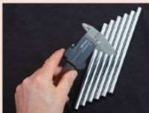
Pied à coulisse avec système sans fil U-WAVE fit
