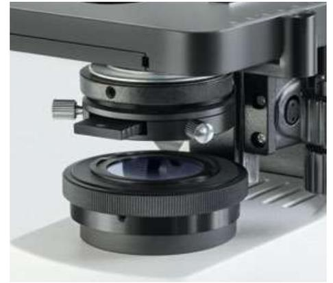
Condenseur de contraste de phase monté
