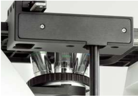
Les boutons coaxiaux de réglage des x/y peuvent être installés à droite ou à gauche
