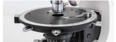
Platine à polarisation, centrable et rotatif
